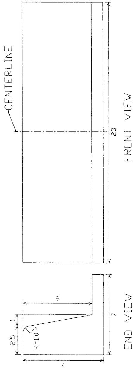
FIGURE 2 - LATERAL FORCE TEST BLOCK
