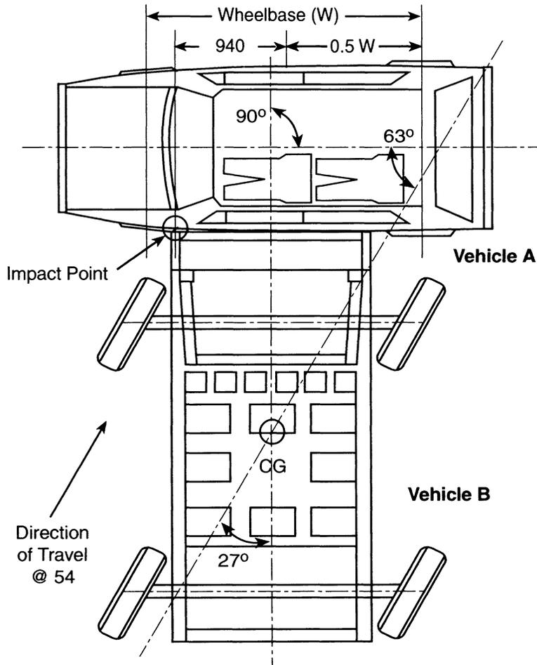
**Figure 3—TEST CONFIGURATION**
